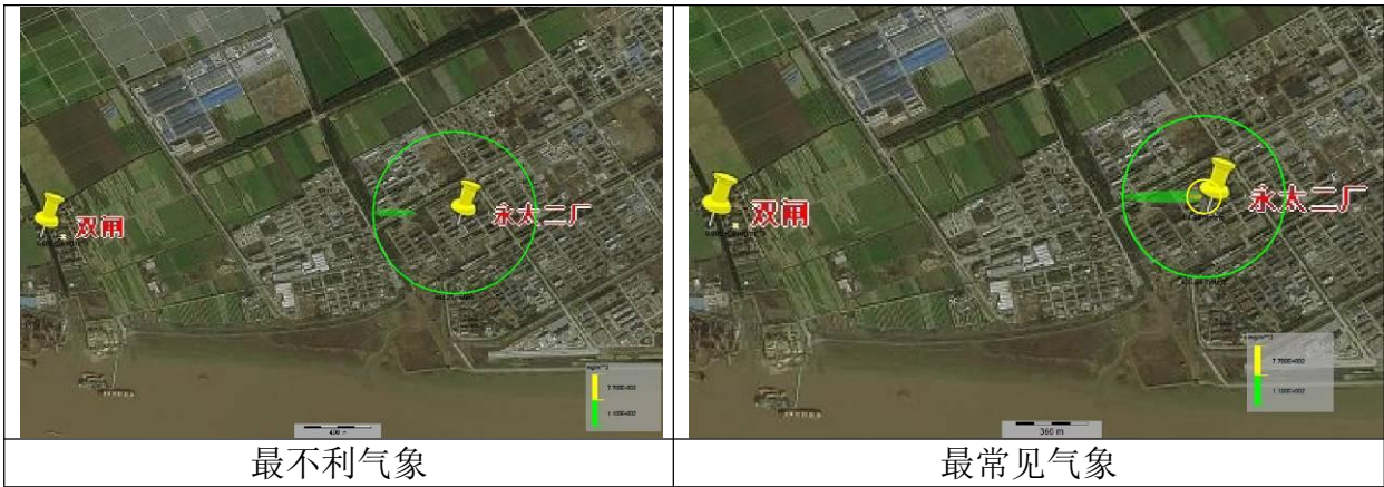
图 6.3.5-7 液氨钢瓶储罐泄漏影响预测图
